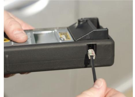
9. Conectar el Módulo OBDII al puerto del Vehículo
